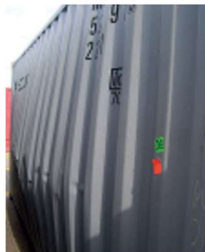
Рис. 9. Деформированная при автоперевозке боковая стенка контейнера
